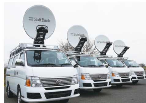
可搬型移動基地局
