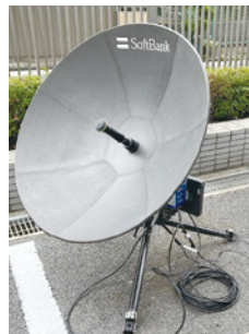
可搬型衛星アンテナ
